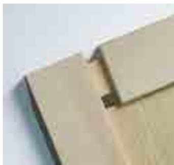
Assemblage par tenon et mortaise
